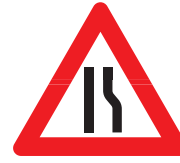
A 43,3: Indsnævret vej i højre side.
