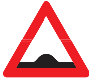
A 36: Hastighedsdæmpende bump. De nye pukkelbump (»puddehatte«) gør at busser og lastbiler kan »skræve« over dem. Hermed undgår chaufføren rygbelastninger.
