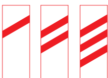
A 75: Afstandsmærker, der tredeler afstanden fra advarselstavlen til jernbaneoverkørslen. Står advarselstavlen (A72/A73) f.eks. 240 m før sporet, vil der være 80 m mellem afstandsmærkerne.
