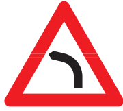
A 41,2: Farligt venstresving.
